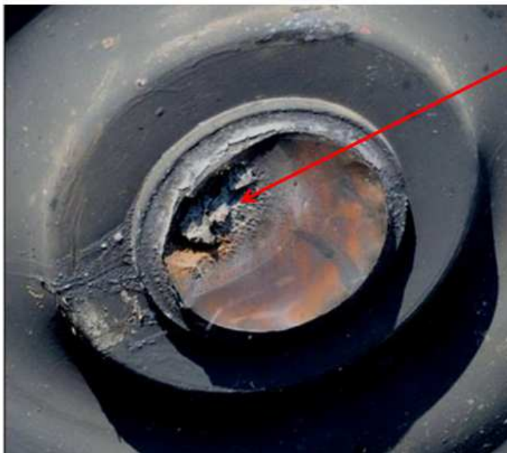
Figura 2.15 - Assile 98331 - Catena causale della «Corrosion fatigue», 5 - Rottura
